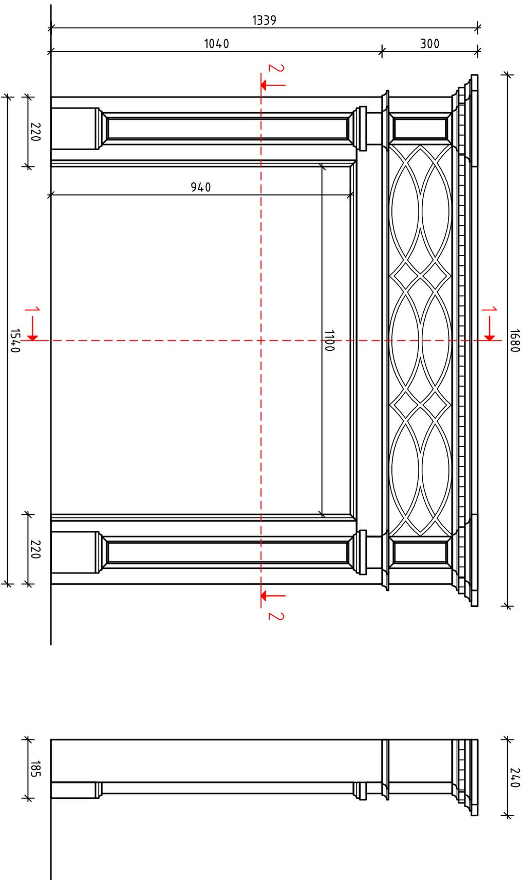
Все детали из мрамора и других камней стыкуются с технологической фазкой 2-5 мм, в зависимости от твердости используемого материала.
