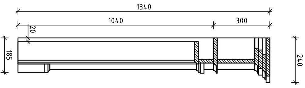
Все детали из мрамора и других камней стыкуются с технологической фрезой 2-5 мм, в зависимости от твердости используемого материала.
