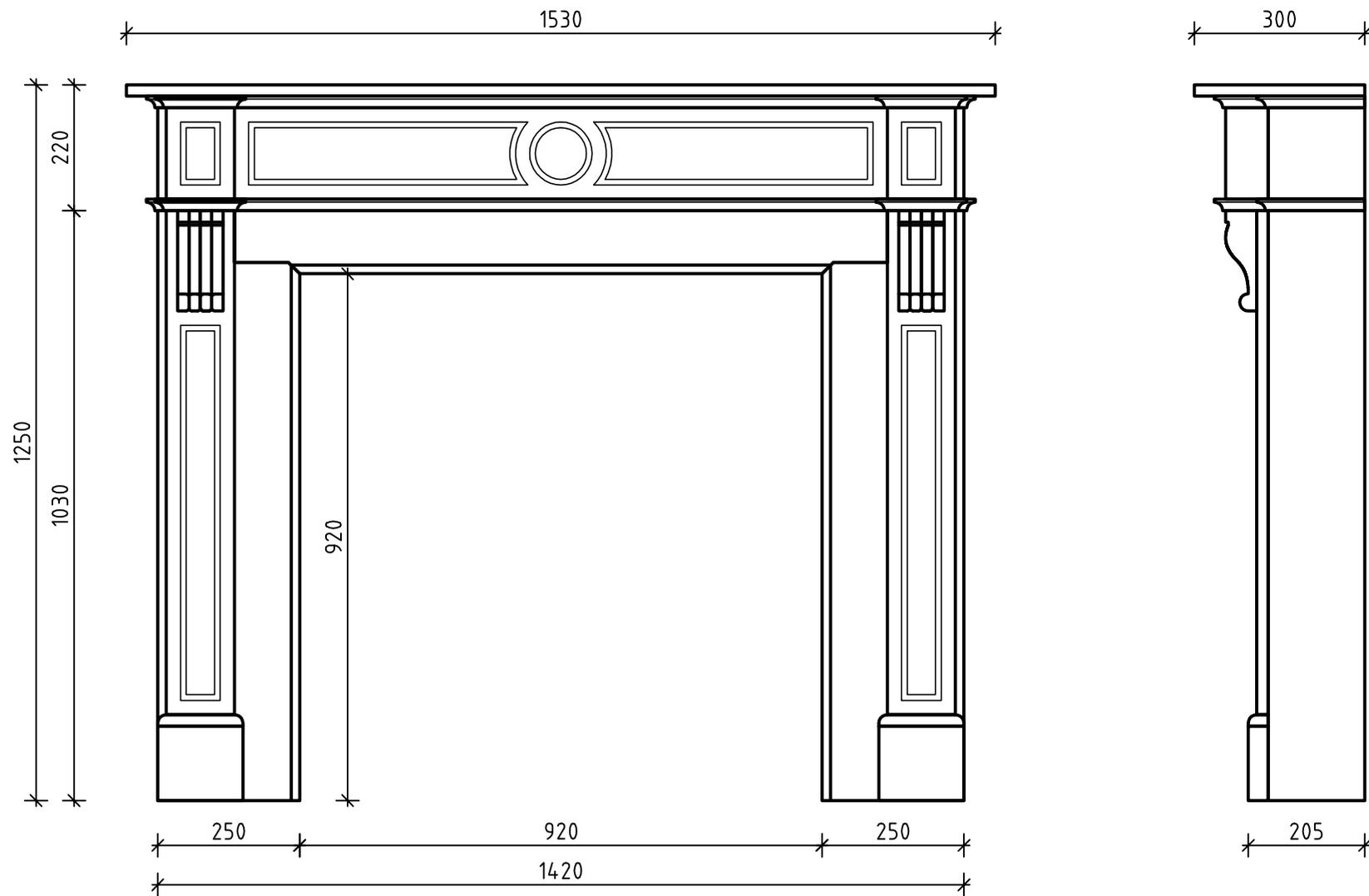
Все детали из мрамора и других камней стыкуются с технологической фаской 2-5 мм, в зависимости от твердости используемого материала.
